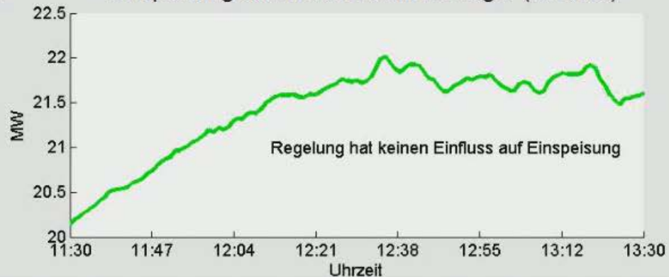
Einspeisung durch dezentrale Erzeuger (NS&MS)
